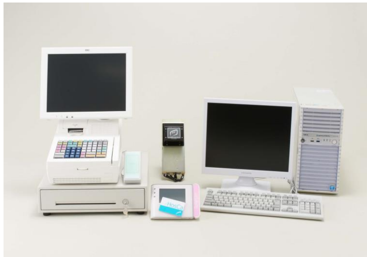
おこづかい HosCa は売店用 POS レジ(左)、残高確認端末、IC カード(以上、中手前)、 自販機用端末(中奥)、管理サーバー(右)などで構成されています
